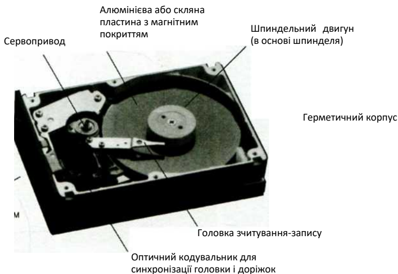
Рисунок 1.1. Основні компоненти типового жорсткого диска
