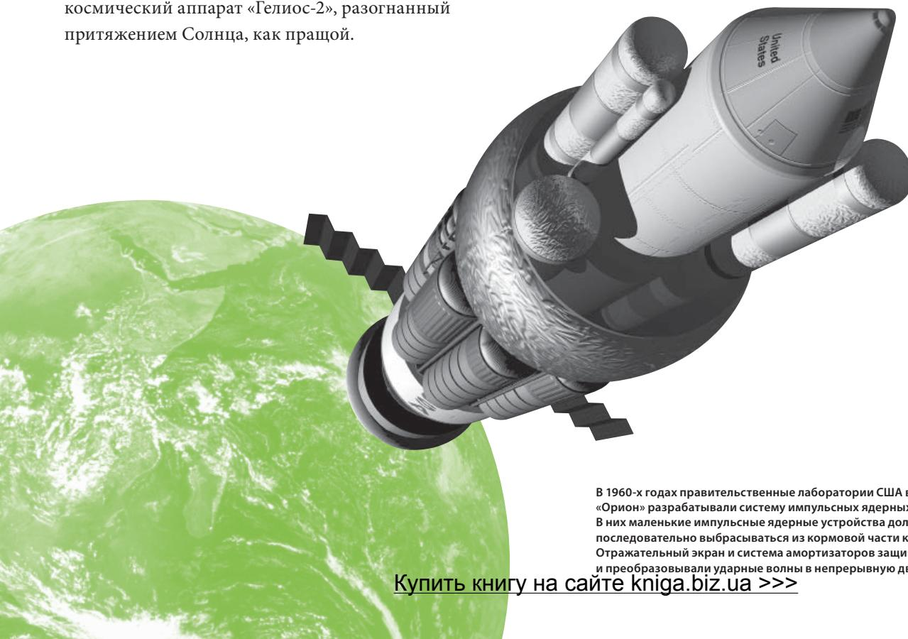
В 1960-х годах правительственные лаборатории США в рамках проекта «Орион» разрабатывали систему импульсных ядерных ракетных двигателей. В них маленькие импульсные ядерные устройства должны были последовательно выбрасываться из кормовой части корабля. Отражательный экран и система амортизаторов защищали бы экипаж и преобразовывали ударные волны в непрерывную движущую силу.
