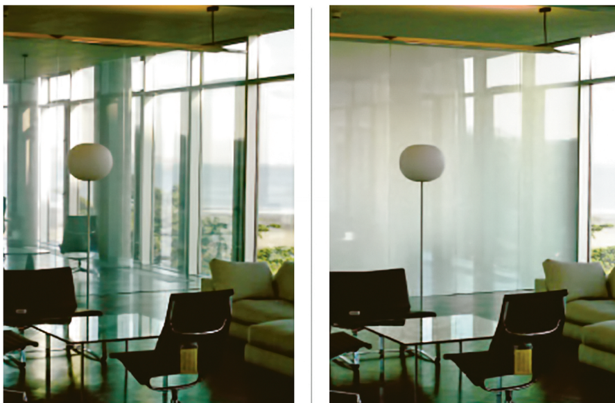
Рис. 1.5. То видно, то не видно: «умное» стекло может автоматически становиться матовым
