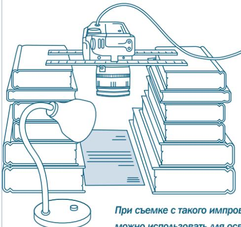
*При съемке с такого импровизированного штатива можно использовать для освещения документов одну или две небольшие настольные лампы.*
