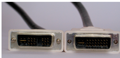
Рис. 1.5. Разъемы DVI-I с одинарной (слева) и двойной (справа) связью
