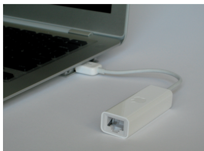
Рис. 1.12. Можно подключить MacBook Air к другому компьютеру Mac, используя сетевой кабель и адаптер USB-Ethernet компании Apple
