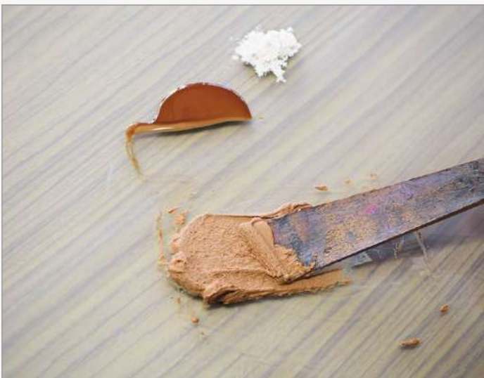
3. Зробіть клей урусі, використовуючи крохмальний клей і кі-урусі, щоб отримати або норі-урусі, який використовують для легких виробів, або мугі-урусі для кераміки та інших речей, які потребують більшої міцності.
