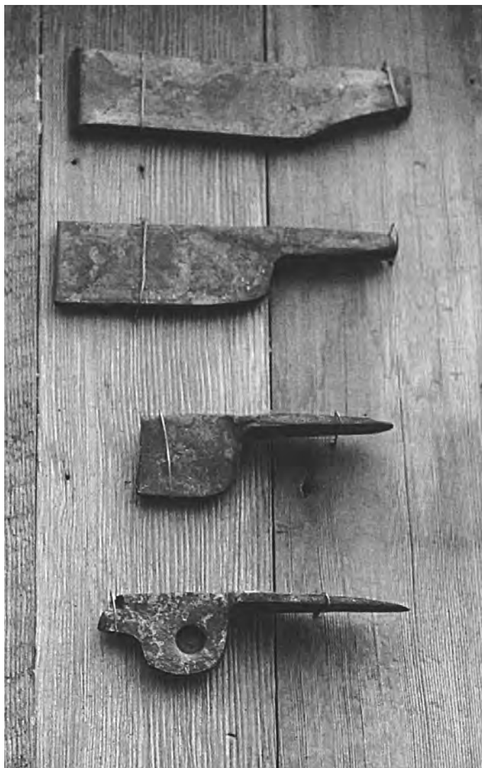
Этапы ковки скального крюка из прутка хромомолибденовой стали 4130.
