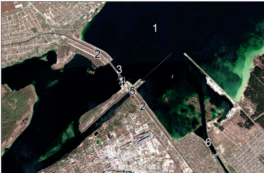
Рис. 6.48. Супутниковий знімок Каховського гідровузла перед руйнуванням: 1 — Каховське водосховище; 2 — ліво- та правобережна земляна гребля; 3 — бетонний водоскид; 4 — будівля ГЕС; 5 — шлюз; 6 — водозабір Північнокримського каналу
