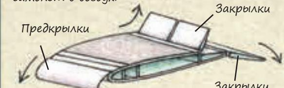
Во время взлета подвижные закрылки и предкрылки поднимаются и опускаются, чтобы изменить размер крыла и подъемную силу самолета.
