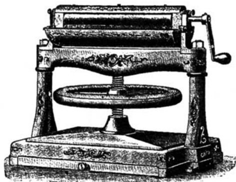
Рис. 5. Копировальный пресс с приставкой для увлажнения валиком, 1886
